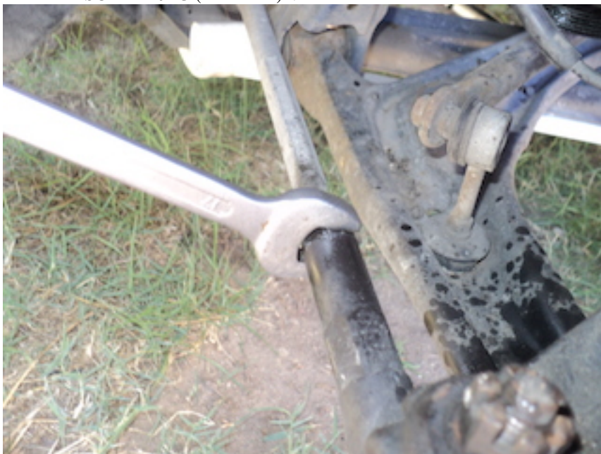
Puis dévisser légèrement l'écrou de serrage de la biellette de direction avec une clé plate de 17 tout en maintenant fermement la rotule de direction intérieure avec la clé plate de 12 ! ( sur la photo on ne voit pas les 2 clés car je n'est qu'une main pour faire la photo ... ). Utiliser du Dégrissant si nécessaire ! DSC02750.JPG (66.26 Kio) Vu 5382 fois
