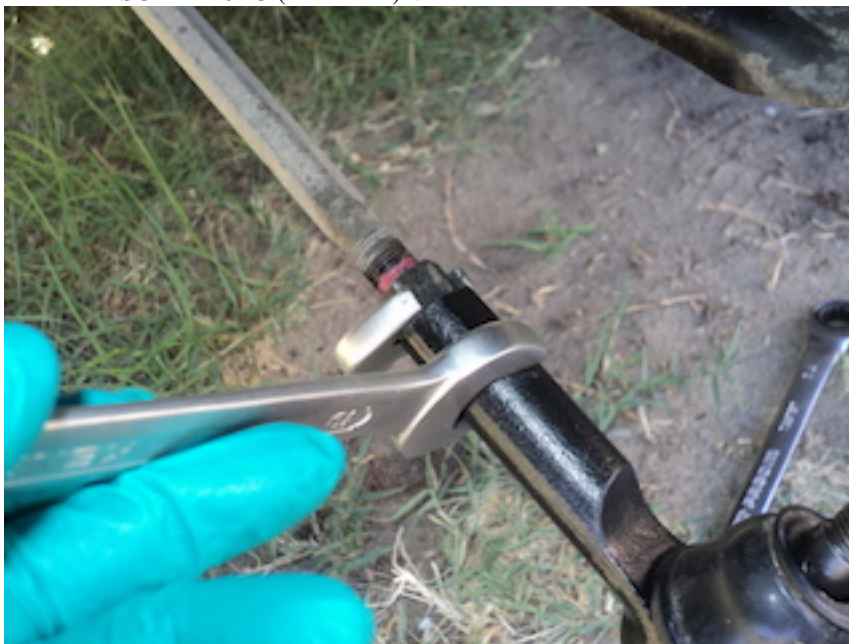
Remonter la nouvelle rotule jusqu'à contact de l'écrou. Vérifier que les mesures précédemment faites sont encore bonnes. Puis serrer l'ensemble avec la clé plate de 17 et la clé plate de 19 ( clé de 19 pouvant varier selon modèle de de rotule. DSC02756.JPG (65.41 Kio) Vu 5382 fois
