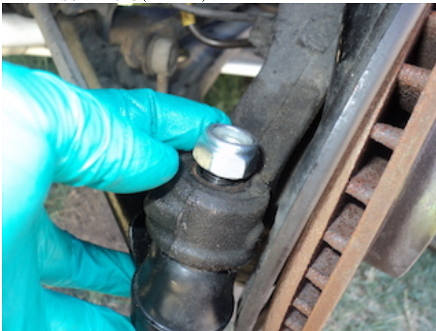
Mettre l'écrou et la goupille ( ici il ni a pas de goupille car c'est un modèle sans goupille et avec écrou Nylstop ). DSC02758.JPG (61.23 Kio) Vu 5382 fois
