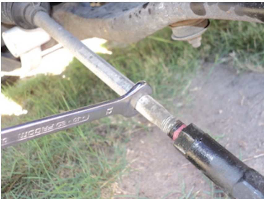
Maintenir la rotule de direction intérieure avec la clé plate de 12 DSC02751.JPG (64.33 Kio) Vu 5382 fois
